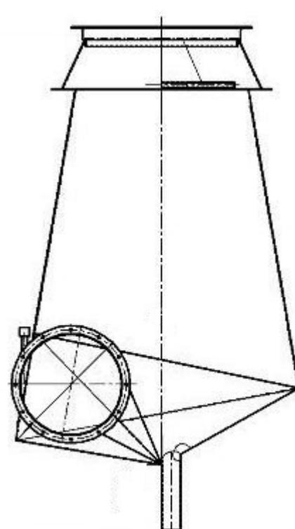
Циклон-промыватель СИОТ состоит из корпуса с входным патрубком и раскручивателя (кроме циклона типа III). Во входном патрубке имеется люк для обслуживания и осмотра циклона во время эксплуатации. Там же расположены два отверстия: одно для наблюдения за движением воды при регулировке работы циклона, другое – для подсвечивания.
